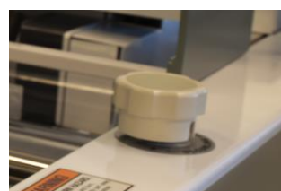
Regolazione barra snervatrice
