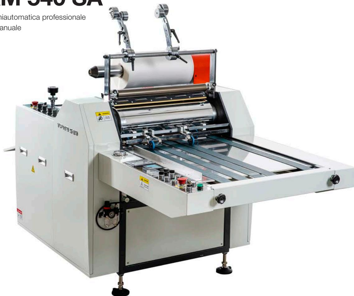
Plastificatrice semiautomatica con mettfoglio manuale tramite nastri trasportatori, sormonto automatico attivabile dal pannello di controllo e rifilo automatico. Rullo superiore di grande dimensione realizzato in acciaio cromato, rullo inferiore in gomma rigida. Barra snervatrice con diversi angoli di regolazione, perforatore previsto sia in entrata che in uscita. In entrata è inoltre prevista un'unità di rifilo del film in eccesso rispetto al foglio da plastificare.
